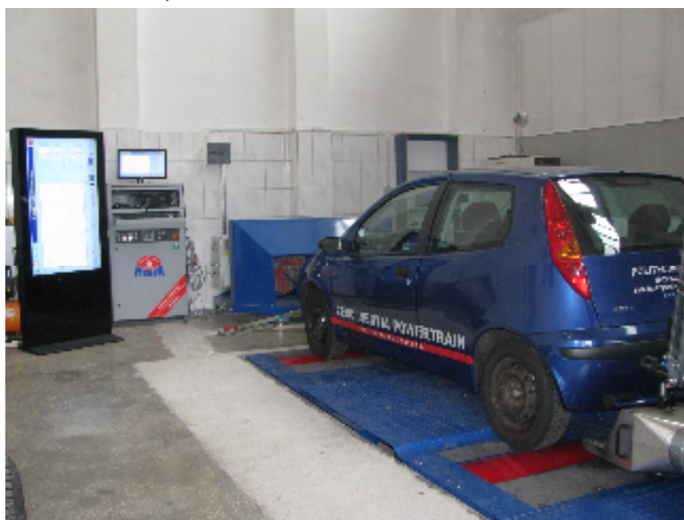
Rys.4. Hamownia podwoziowa MAHA MSR 500 będąca na wyposażeniu Katedry Pojazdów Drogowych i Rolniczych
