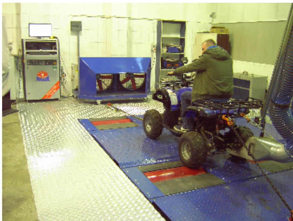
Rys.3.1. Hamownia podwoziowa MAHA MSR 500 będąca na wyposażeniu Katedry Pojazdów Drogowych i Rolniczych
