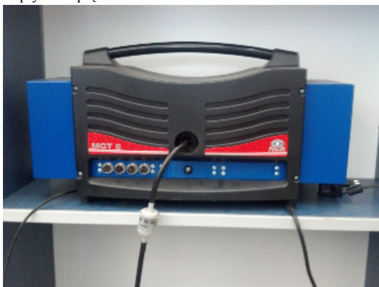
Rys.3.2. Analizator spalin MAHA MGT 5 będący na wyposażeniu Katedry Pojazdów Drogowych i Rolniczych
